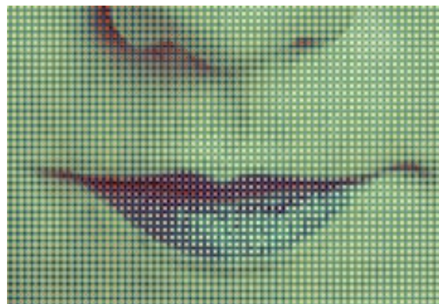
FIGURA 9. Un'immagine RAW con i colori del filtro di Bayer assegnati ai dati dei singoli fotositi.
