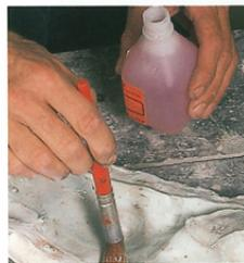
**1** Quando si realizza un calco con la resina, lo stampo deve essere assolutamente asciutto, poiché l'acqua impedisce che la resina si polimerizzi correttamente. Dipingete generosamente le superfici dello stampo con un agente di distacco idrosolubile, come raccomandato dal produttore della resina. Non lasciate che l'agente di distacco si raccolga in determinati punti. Lasciate asciugare.
