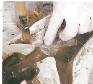
**3** Tagliate il materiale in fibra di vetro in strisce a coprire due volte le superfici dello stampo. Pesate poco resina colorata e aggiungete la quantità raccomandata di induritore. Questo strato in resina non contiene colore. Lavorando sistematicamente, rivestite una piccola area del rivestimento in gel coat polimerizzato con resina, poi posizionate strisce sovrapposte di materiale in fibra di vetro nella resina, non appena l'avete dipinta. Lasciate che il materiale si impregni di resina.
