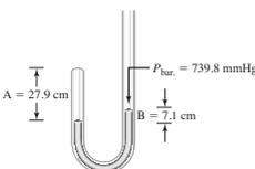
All'inizio dell'esperimento l'altezza della colonna d'aria (A) sulla sinistra era di 30.5 cm e l'altezza del mercurio nei due rami del tubo era uguale. Aggiungendo mercurio nel ramo di destra si produce una differenza nel livello del mercurio (B) e l'aria intrappolata nella parte sinistra viene compressa in un tratto di tubo più corto (minor volume). Ad esempio, nell'illustrazione, A = 27.9 cm e B = 7.1 cm. I valori di A e B di Boyle, in centimetri, sono qui elencati:
