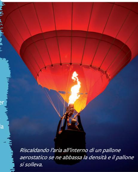
*Riscaldando l'aria all'interno di un pallone aerostatico se ne abbassa la densità e il pallone si solleva.*
