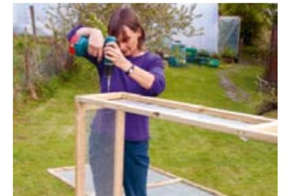
Inserire due viti da 5 mm per 60 mm alle estremità di ciascun fianco per assemblare la base. I fianchi si sovrappongono alle teste; fare attenzione a non cozzare con altre viti. Fissare il tetto alla base con le viti da 4 mm x 40 mm distanziandole di 60 cm.
