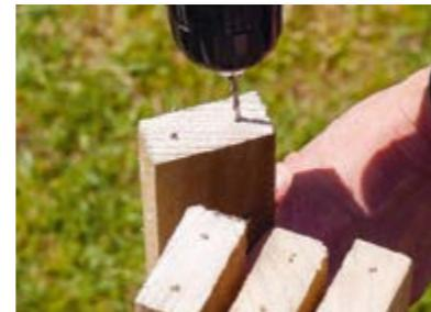
Con la punta da 4 mm, praticare fori da 10 mm alle estremità dei pezzi segnati allo Step 2. I fori pilota guideranno le viti in posizione corretta. NB: per evitare incidenti è sempre meglio bloccare il legno con una morsa o dei morsetti.
