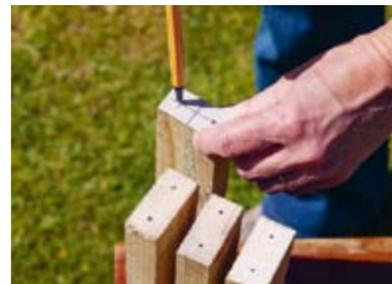
Segnare due punti a 10 mm dalle due estremità di cartoncino da 50 mm per 25 mm. Usare questa dima per segnare i punti di foratura alle estremità dei pezzi da 21 cm e alle estremità di tutti i pezzi da 112 cm.
