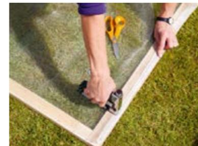
Allargare la rete e disporre gli elementi. Tagliarla la rete a misura per ciascun elemento, lasciando 10 mm di sovrappiù. Allargare la rete sulla superficie interna di ciascun elemento, ripiegando i 10 mm di eccedenza per dare doppio strato ai margini, e fissare con abbondanti graffette.
